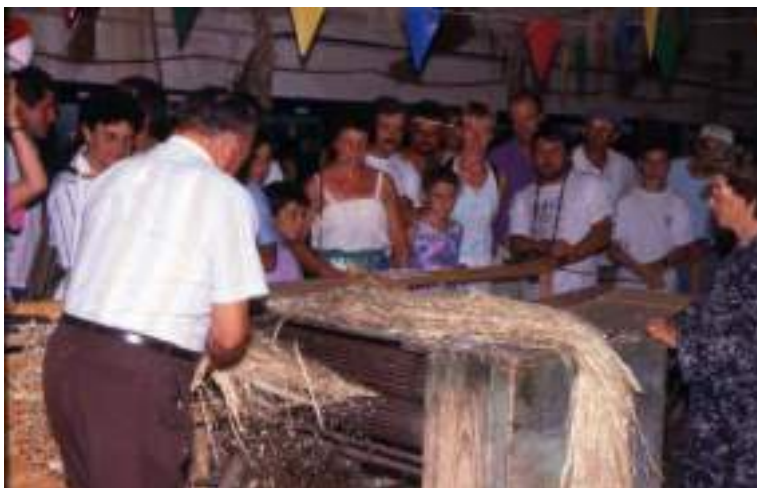
Brayage à la brayeuse mécanique à cylindres cannelés par Henri et Annette Brechet
